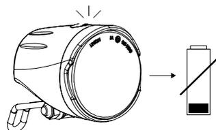
Das Vorderlicht wird inklusive vier vormontierten AAA Alkaline Akku geliefert. Vor der ersten Verwendung muss ein Sicherheitsstreifen aus Kunststoff, welcher die Batterie schützt, entfernt werden.
