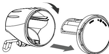
3. Ersetzen Sie die Alkaline Akku (1,5 V - 1500 mA) und montieren Sie den Vorderschutz.
