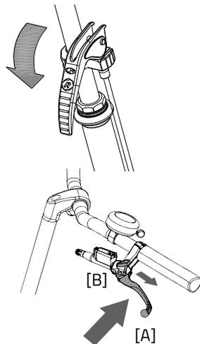
Pour activer le frein hydraulique, serrez le frein gauche [A] et fixez-le à l'aide du levier [B].
