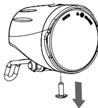
2. Retirez le couvercle avant en le tournant légèrement et en le tirant vers l'avant.
