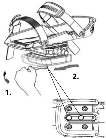
Die Fußschale ist auch in der Breite verstellbar. Nur die äußere Hälfte der Fußschale kann herausgeschoben werden.
