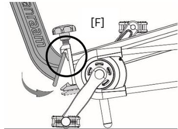
des Sternen Hand Knauf fest. Heben Sie das Fahrrad vorne leicht an, um sicherzustellen, dass die Verbindung einwandfrei ist. **Bitte beachten!**
