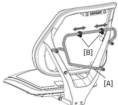
**Achtung!** Die Gepäckplattform verschiebt sich zusammen mit dem Sitz. Achten Sie auf das Kippverhalten des Fahrrads, wenn die Plattform in der äußersten Position maximal belastet ist.
