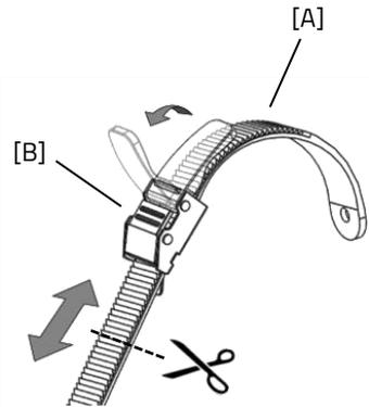
Die Position der Fußfixierung auf dem Pedal ist in der Länge verstellbar. Dadurch können Sie mit dem Fußballen treten, um eine optimale Krafteinwirkung zu erzielen.
