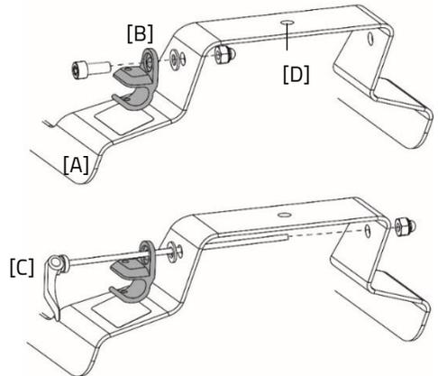
Der Adapter für Ihren Fahrradanhänger [B] kann mit dem im Lieferumfang enthaltenen Montagematerial auf der linken Seite der Halterung montiert werden/ Möglicherweise haben Sie einen Schnellspanner [C], der zu Ihrem Fahrradanhänger gehört, dieser kann ebenfalls an der Fahrradanhängerhalterung montiert werden.
