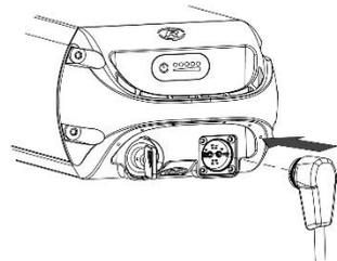
10. Setzen Sie den Akku wieder in die Halterung am Fahrrad ein und verriegeln Sie ihn. Der Akku kann eventuell auch direkt in der Halterung aufgeladen werden.
