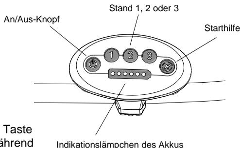
Der Motor hat eine Starthilfe. Hiermit kann der/die Fahrer/in bis zu einer Geschwindigkeit von etwa 5 km/h. beschleunigen, ohne selbst mitzutreten. Um zu beschleunigen, drücken Sie auf den Knopf und halten Sie ihn eingedrückt. Der Motor wird erst nach einige Sekunden aktiviert.
