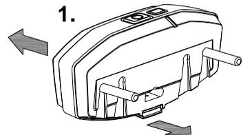
2. Tauschen Sie die Alkaline-Batterien aus (1,5 V - 1500 mA) und montieren die Kappe.
