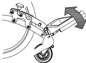
4. Sollten diese Positionen nicht zureichend sein, gibt es noch eine weitere Stellmöglichkeiten. Die Fußstütze kann eine Position weiter nach vorne oder nach hinten montiert werden. Um dies zu tun:
