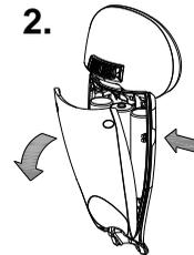
3. Tauschen Sie die Alkaline-Batterien aus (1,5 V - 1500 mA) und montieren Sie die Rückseite.
