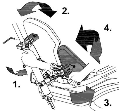
Positionieren Sie abschließend die Seitenstützen. Um diese einzustellen:
