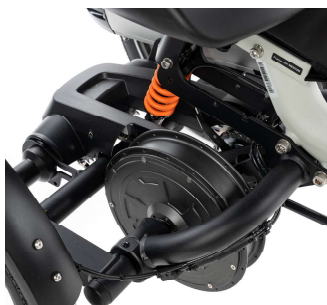
Der Nabenmotor vanRaam Silent Elektro HT mit 60 Nm Drehmoment.
