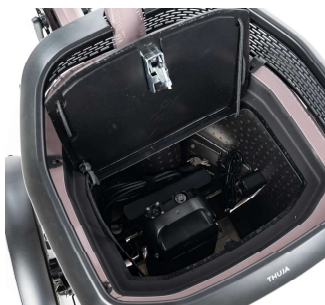
Im abschließbaren Frontlader steckt der abnehmbare Akku.
