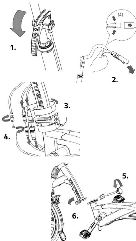
Um das Fahrrad wieder zusammenzubauen, führen Sie die folgenden Schritte in umgekehrter Reihenfolge aus. Achten Sie beim Anschließen der Kabel darauf, dass sich die Pfeile oder Stifte direkt gegenüberliegen.
