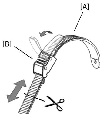
Die Position der Fußfixierung auf dem Pedal ist in der Länge verstellbar. Dadurch können Sie mit dem Fußballen treten, um eine optimale Krafteinwirkung zu erzielen.
