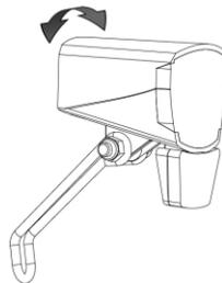
Stellen Sie den Winkel des Scheinwerfers so ein, dass die Mitte des Lichtstrahls etwa zehn Meter vor dem Fahrrad liegt.
