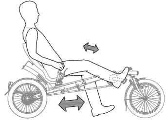
Als Faustregel für die Einstellung der Sitzposition gilt Folgendes. Der Fahrer sitzt auf dem Fahrrad und stellt einen Fuß auf das Pedal in der am weitesten vom Fahrer entfernten Position. Stellen Sie die Sitzposition so ein, dass das Bein ausgestreckt, aber noch entspannt ist. Die bequemste Position können Sie in der Praxis selbst ermitteln. Die Sitzposition wird durch Einstellen der Rahmenlänge auf den richtigen Abstand eingestellt. Führen Sie dazu die folgenden Schritte aus:
