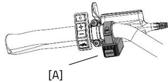
Das Blinkerset wird über den Akku des Silent Elektrosystems mit Strom versorgt.
