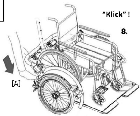
7. Verwenden Sie das Bedienfeld, um die Winde zurück zu spulen. Halten Sie den Knopf gedrückt und führen Sie gleichzeitig den Rollstuhl so, dass er gerade auf die Rampe gestellt wird.
