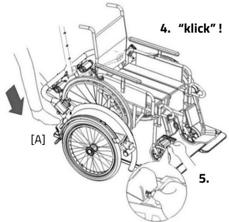
**Wichtig!** Achten Sie darauf, dass die Platte durch das Gewicht des Rollstuhls von alleine hochklappt, sobald der Rollstuhl auf der Auffahrrampe steht. In dem Moment befindet sich der Schwerpunkt des Rollstuhls oberhalb der Vorderräder des Fahrrads. Dies sorgt für die richtige Gewichtsverteilung des Fahrrades.
