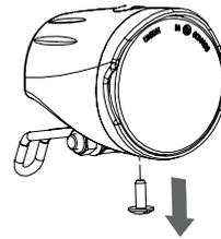
2. Demontieren Sie den Vorderschutz des Scheinwerfers, indem Sie ihn ein wenig drehen und nach vorne ziehen.
