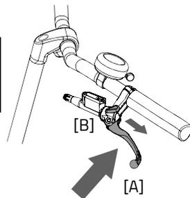
Um die hydraulische Bremse zu festzumachen, ziehen Sie die linke Bremse fest [A] und stellen Sie die Bremse mit dem kleinen Hebel [B] fest.
