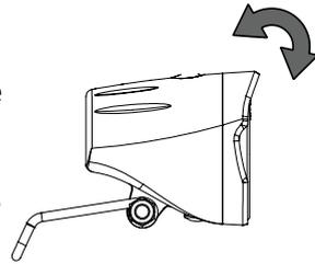
Stellen Sie den Winkel des Scheinwerfers so ein, dass der Mittelpunkt des Lichtstrahls etwa zehn Meter vor dem Fahrrad liegt.
