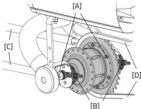
1. Lösen Sie die Muttern [A] auf beiden Seiten der Nabe.
