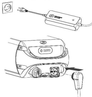
10. Setzen Sie den Akku wieder in die Halterung am Fahrrad ein und verriegeln Sie ihn. Der Akku kann eventuell auch direkt in der Halterung aufgeladen werden.
