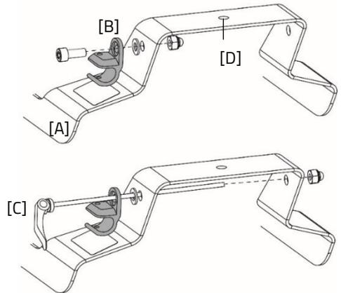
Der Adapter für Ihren Fahrradhänger [B] kann mit dem im Lieferumfang enthaltenen Montagematerial auf der linken Seite der Halterung montiert werden/ Möglicherweise haben Sie einen Schnellspanner [C], der zu Ihrem Fahrradhänger gehört, dieser kann ebenfalls an der Fahrradhängerhalterung montiert werden.
