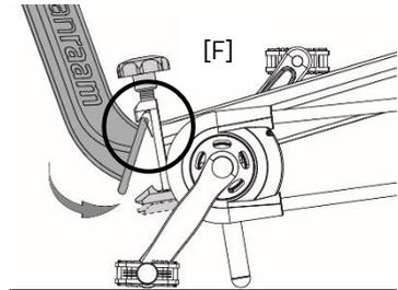
des Sternens Hand Knauf fest. Heben Sie das Fahrrad vorne leicht an, um sicherzustellen, dass die Verbindung einwandfrei ist. **Bitte beachten!**
