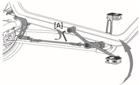
Danach kann die feststehende Kurbel auf die gewünschte Höhe eingestellt werden. Ziehen Sie anschließend die Schraube wieder an.
