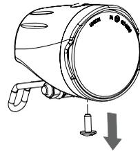
2. Demontieren Sie den Vorderschutz des Scheinwerfers, indem Sie ihn ein wenig drehen und nach vorne ziehen.
