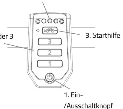
Nachdem das System eingeschaltet wurde, ist der Motor aktiv auf Stufe 1.
