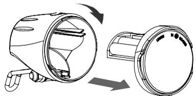
3. Ersetzen Sie die Alkaline Batterien (1,5 V - 1500 mA) und montieren Sie den Vorderschutz.
