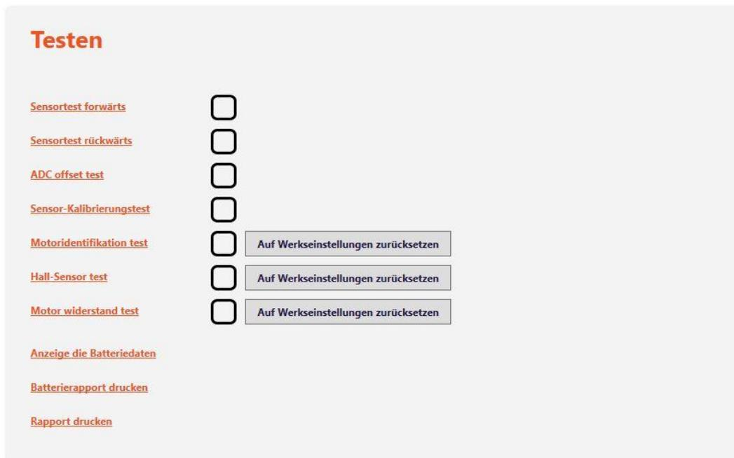
Bei 3 Tests gibt es eine Schaltfläche "Auf Werkseinstellungen zurücksetzen", wenn Sie die Tests durchgeführt haben und der Motor immer noch nicht richtig funktioniert, dann können die Einstellungen durch Anklicken dieser drei Schaltflächen auf die Werkseinstellungen zurückgesetzt werden. Danach sollten alle Tests erneut durchgeführt werden, um den Motor erneut zu identifizieren.
