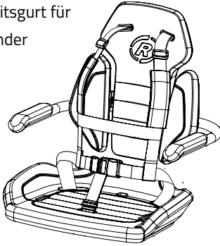
Vier- und Fünfpunkt- Sicherheitsgurt für Erwachsene
